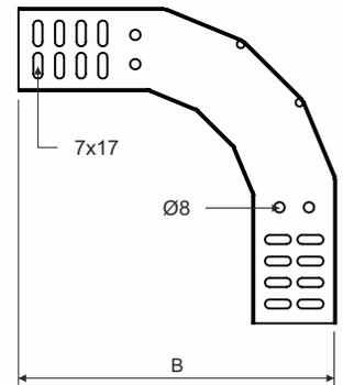
**Produktbeschreibung:** Das Steigstück ist für den Übergang von einer horizontalen zu einer vertikalen Kabelrinne konzipiert. Das Steigstück kann auch bei Kabelleitern verwendet werden.
