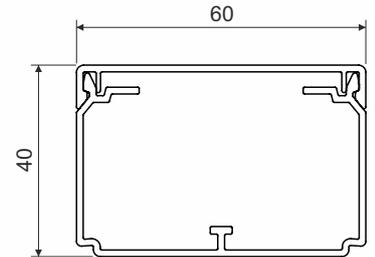
Produktbeschreibung:: bestimmt zur Installation von Niederspannungsleitungen
