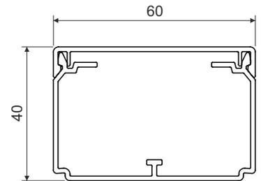
**Produktbeschreibung:** geeignet zur Verlegung von Niederspannungsleitungen
