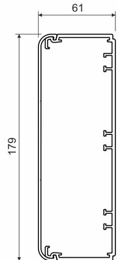
Produktbeschreibung: geeignet zur Verlegung von Niederspannungsleitungen
