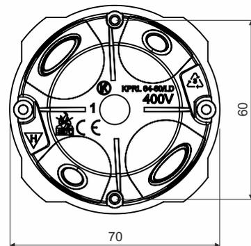
Produktbeschreibung: geeignet für Leitungen mit einer Spannung bis 400 V und einer Stromstärke von max. 16 A
