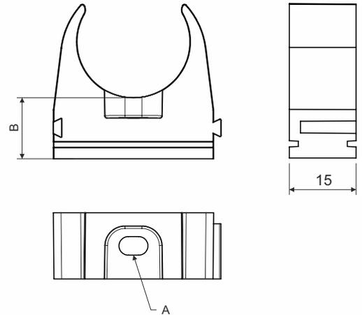
Produktbeschreibung: die Clippschelle dient der Befestigung der Rohrleitung am Grundmaterial
