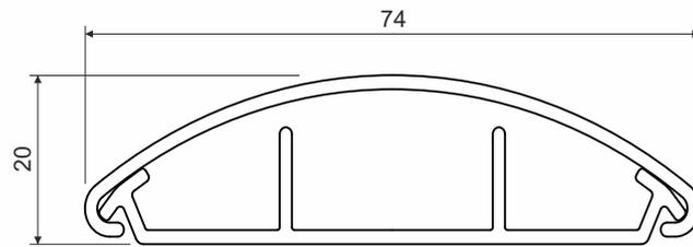
Produktbeschreibung: geeignet zur Verlegung von Niederspannungsleitungen
