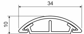
Produktbeschreibung: geeignet zur Verlegung von Niederspannungsleitungen
