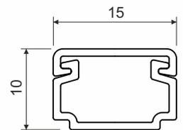
Produktbeschreibung: geeignet zur Verlegung von Niederspannungsleitungen
