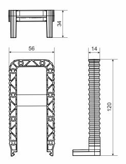
Produktbeschreibung: flexible Montageflügel zur direkten Befestigung an der Bewehrung
