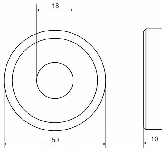
Produktbeschreibung: Befestigungsmagnet für die Montage von Betondosen auf einer Stahlschalung
