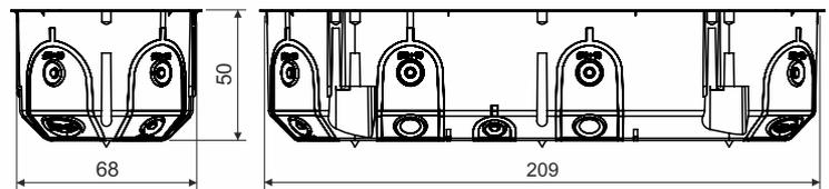
**Produktbeschreibung:** geeignet für Leitungen mit einer Spannung bis 400 V und einer Stromstärke bis max. 16 A
