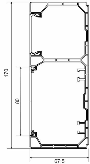
Produktbeschreibung: vorgesehen für die Installation von Niederspannungsleitungen ausgelegt für die Verlegung von Strom- und Kommunikationsschaltkreisen sowie Sicherheitsleitungen u.v.m. zwei getrennte Kammer mit jeweils einem entsprechenden Deckel geeignet zum Einbau von Gerätedosen mit gängigen Modulen Montage von modularen Geräten QUADRO ohne weiteres Zubehör weiße Kanäle sind kein Nährboden für Bakterien \*, getestet im SZÚ gemäß der Norm ČSN EN ISO 846:2019
