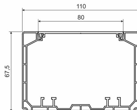
**Produktbeschreibung:** vorgesehen für die Installation von Niederspannungsleitungen
