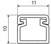
Produktbeschreibung:: bestimmt zur Installation von Niederspannungsleitungen
