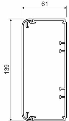
**Produktbeschreibung:** geeignet zur Verlegung von Niederspannungsleitungen
