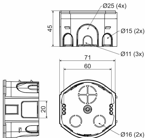
Produktbeschreibung: geeignet für Leitungen mit einer Spannung bis 400V
