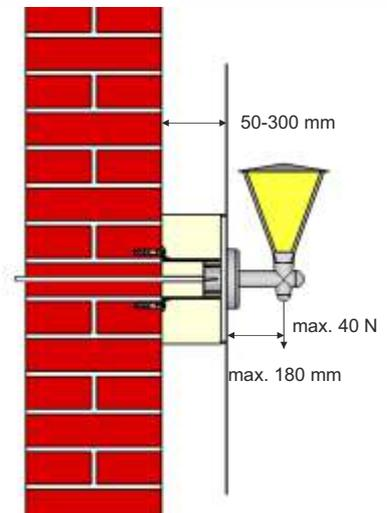
Vor der Montage ist die Halterung inkl. beigelegter Isolierung auf die benötigte Länge, entsprechend der Wärmedämmungsstärke, zu kürzen.
