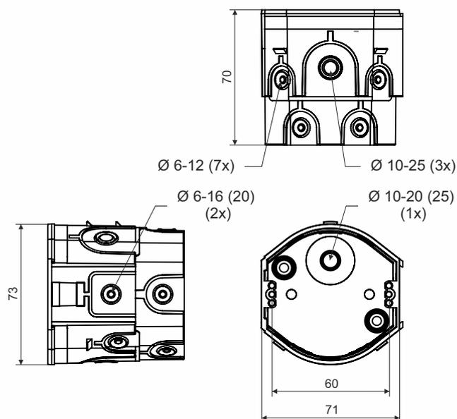
Produktbeschreibung: geeignet für Leitungen mit einer Spannung bis 400V und Stromstärke bis max. 16 A
