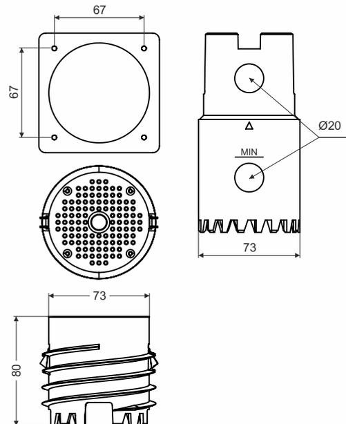
**Produktbeschreibung:** zum Einbau von Geräten (Bewegungssensoren, Kameras etc.) in wärme gedämmte Fassaden ab 80 mm Dämmstärke geeignet für gängige Dämmstoffe (Styropor, Mineralwolle)
