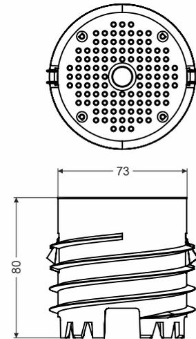
**Produktbeschreibung:** zum Einbau von Geräten (Bewegungssensoren, Kameras etc.) in wärmegeämmte Fassaden ab 80 mm Dämmstärke geeignet für gängige Dämmstoffe (Styropor, Mineralwolle)
