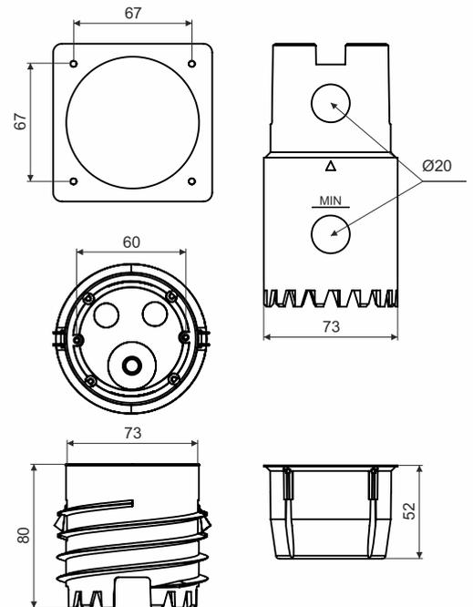
**Produktbeschreibung:** zum Einbau von Geräten in gedämmte Fassaden ab 80 mm Dämmschichtdicke
