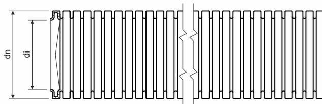
**Produktbeschreibung:** flexibles Wellrohr aus PP, halogenfrei, flammwidrig
