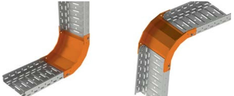
Für eine vertikale Biegung in einem beliebigen Winkel, kleiner 90°, eignet sich die Gelenkverbindung SK. Sie ermöglicht Biegungen im Winkel von 1° bis 75° und ist somit besonders vorteilhaft für kleinere Richtungsänderungen.
