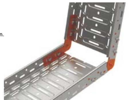
Es ist empfehlenswert, die Kabelrinnen so zu modifizieren, dass der leere Raum in Rinnenboden möglichst gering gehalten wird. Dazu dienen u.a. Eckenbaustücke.
