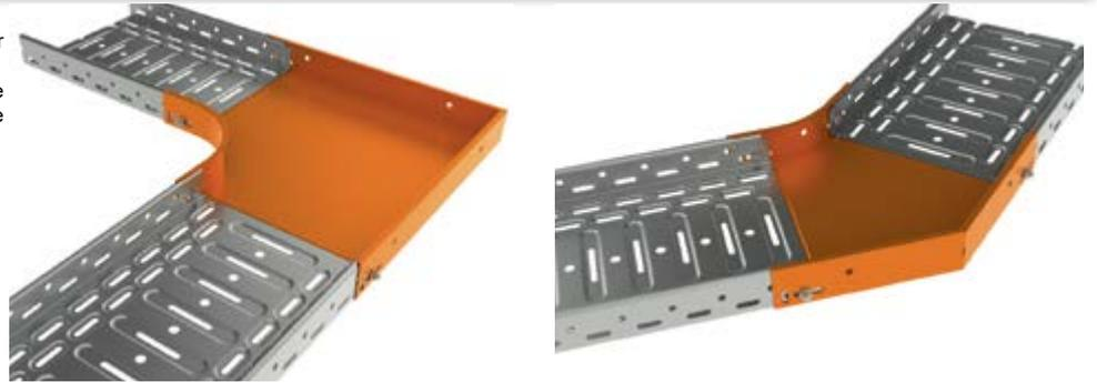
Eine horizontale Biegung der Trasse kann auch mit der Kupplung NSUK gebildet werden. Die Kupplung ermöglicht eine Biegung in einem vom Kunden gewünschten Winkel. Dazu wird die Kabelrinne entsprechend geschnitten und die Kupplung, im gewünschten Winkel gebogen, angeschraubt.
