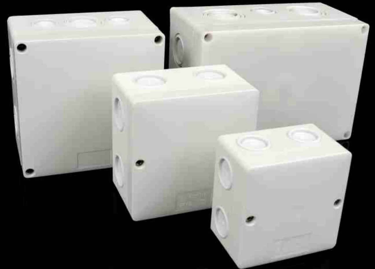
Abzweigdosen KSK sind geeignet für die Räume mit höheren Anforderungen für Schutz gegen Wassereindringung. Sie erfüllen die Ansprüche auf Schutzart IP66 – kompletter Schutz gegen Staub und intensiv spritzendes Wasser – also können auch in den Räumen mit hoher Feuchtigkeit angewendet werden.
